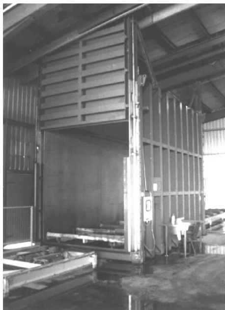
Figura 4.9. Cooler cu vacuum folosit la răcirea vegetalelor care se păstrează după recoltare (Tompson, J... și alții, 1998) (Photo courtesy of Intercoast ExpressPty. Ltd., Werribee South, Victoria, Australia)
